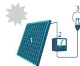
1. Zonnepaneel | 2. Omvormer | 3. Elektrische toestellen
